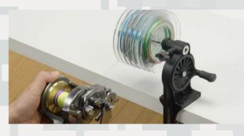
新品线可以在调节张力的同时卷入卷轴中。 ※请按照图示将线从线轴上方引出。
